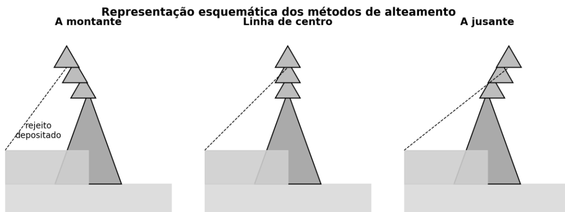
Figura 2 - Representação esquemática dos métodos de alteamento
