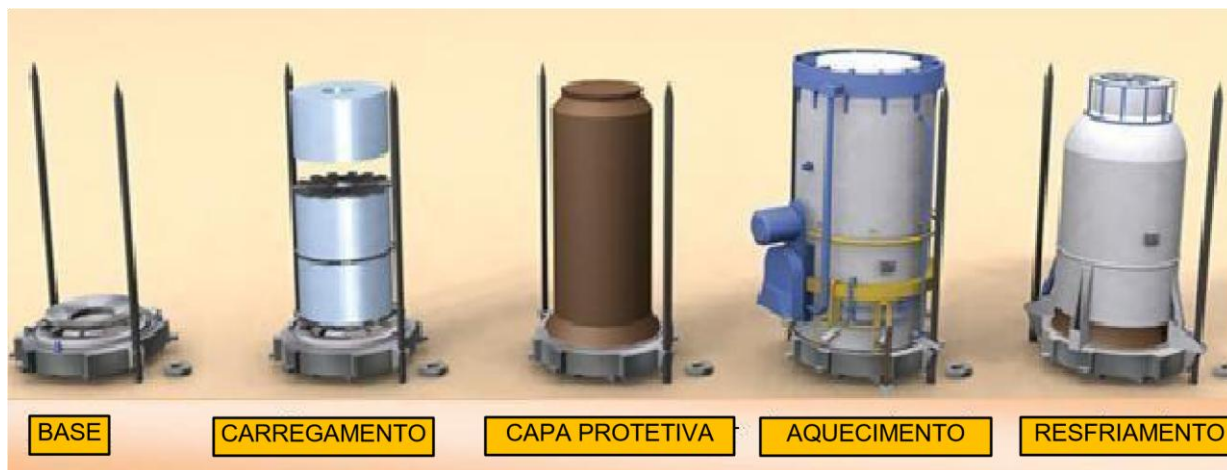
Figura 3.7. Equipamento do recozimento em caixa – BAF (SARAE, MOHAMAD, 2011).
