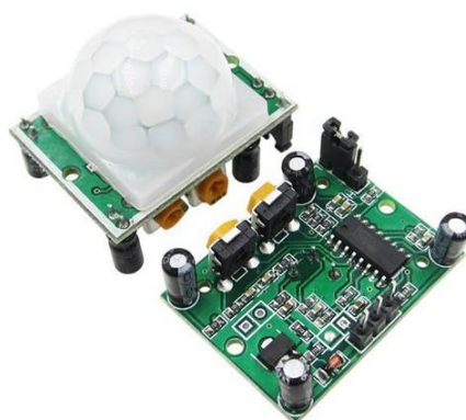
Figura 7 – Sensor de Movimento PIR (HC-SR501). Fonte: Pires (2023)
