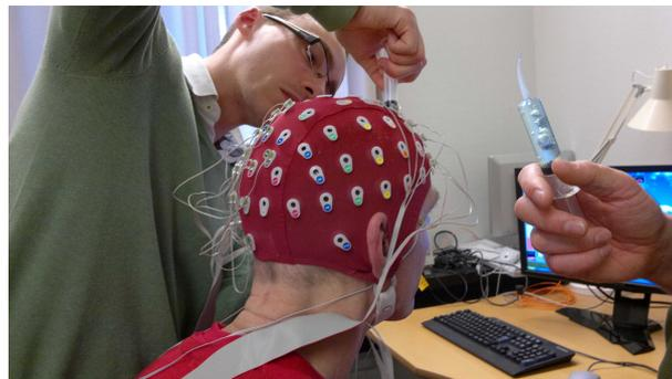
Figura 3: Equipamento de Eletroencefalografia (EEG)
