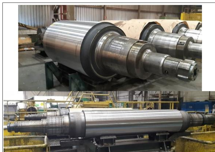
Figura 8: Exemplos de cilindros utilizados no processo de laminação de perfis
