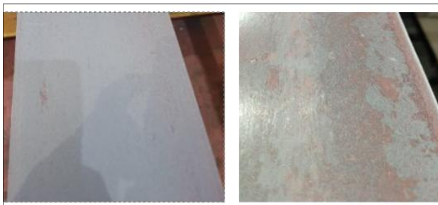
Figura 9: Perfis laminados sem vs. com desgaste de cilindro
