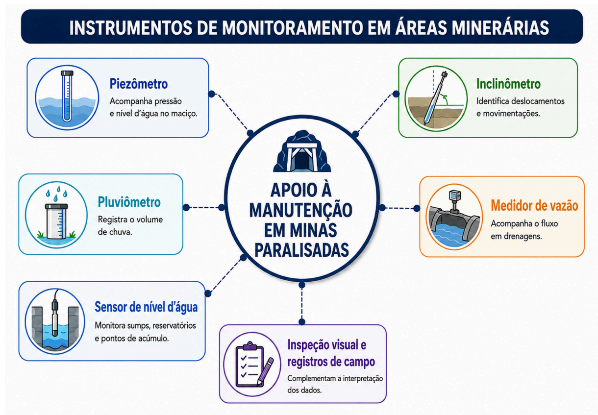
Figura 10 – Instrumentos de monitoramento em áreas minerárias
