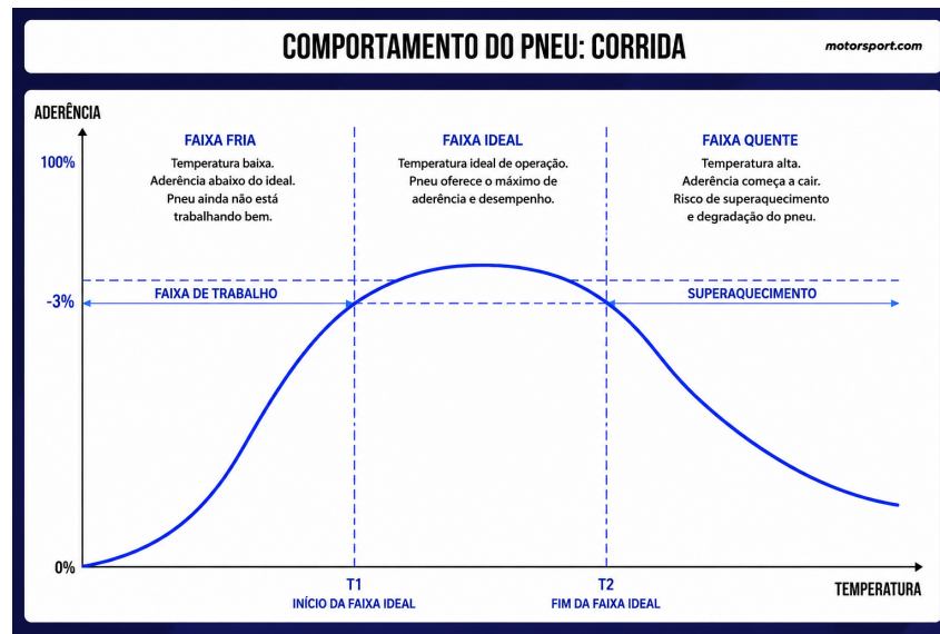
Figura 3 – Representação do comportamento de um composto de pneu arbitrário durante uma corrida de Fórmula 1.
