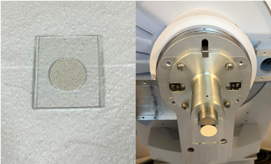
Figura 10: Amostra de pó da brita preparada para análise por difração de raios X e encaixe do porta amostras no equipamento.
