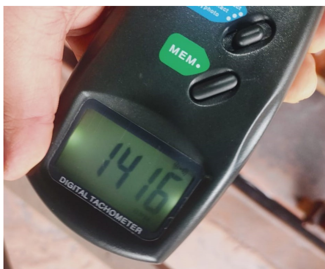
Figura 39 – Medição da rotação do motor utilizando tacômetro. Fonte: autor.
