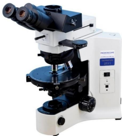
Figura 7 - Microscópio petrográfico Olympus BX41 utilizado nas análises das inclusões fluidas.
