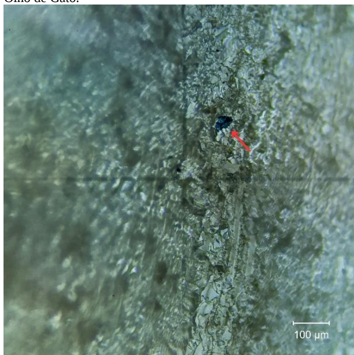
Figura 21 - Inclusão sólida azul-escura associada a faixa interna heterogênea em cristal de berilo da amostra Olho de Gato.
