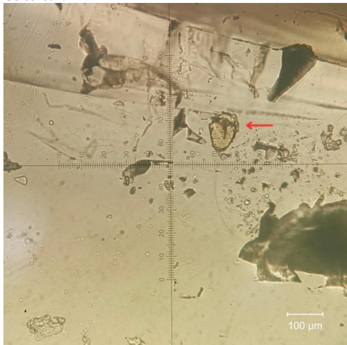
Figura 16 - Inclusão sólida acastanhada associada a descontinuidade interna em cristal de berilo da amostra Golconda I.
