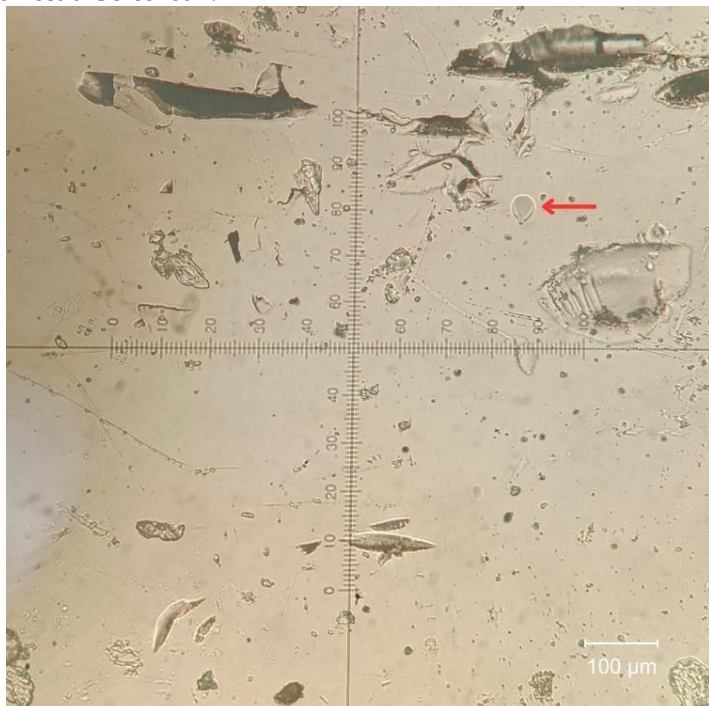
Figura 14 - Inclusões fluidas, cavidades irregulares e feições alongadas observadas em cristal de berilo da amostra Golconda I.
