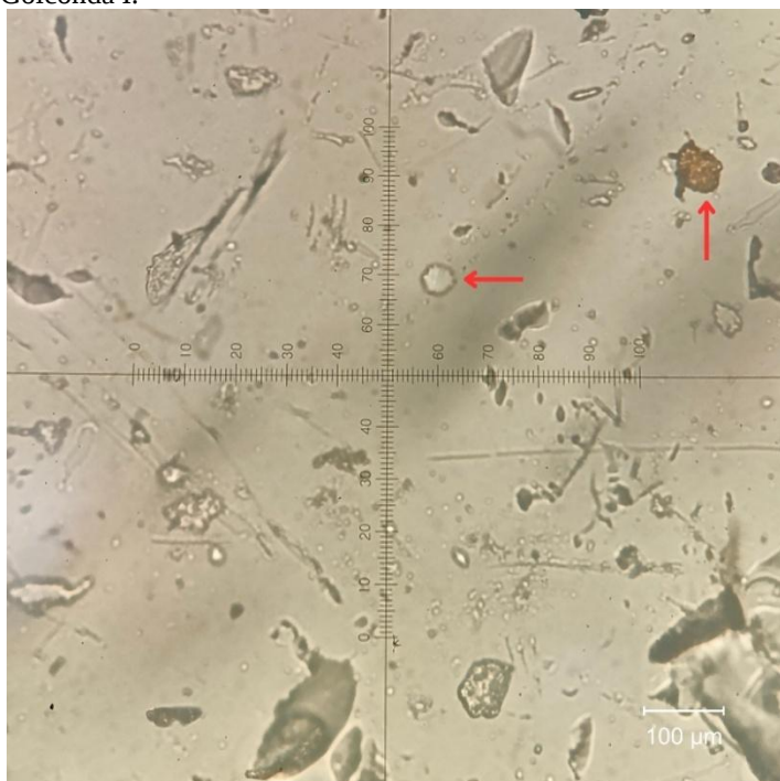
Figura 15 - Associação entre inclusão fluida e inclusão sólida observada em cristal de berilo da amostra Golconda I.
