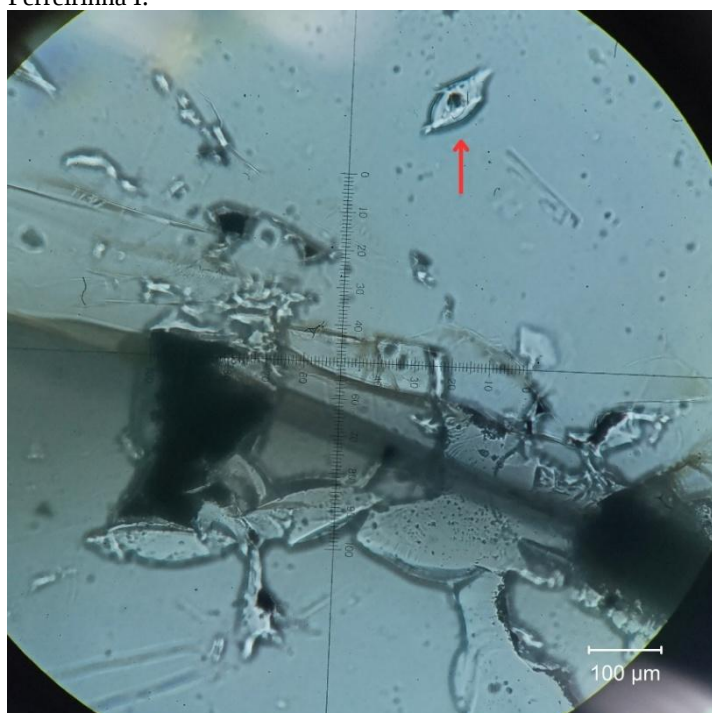
Figura 12 - Inclusão fluida bifásica (L+S) de morfologia lenticular observada em cristal de berilo da amostra Ferreirinha I.
