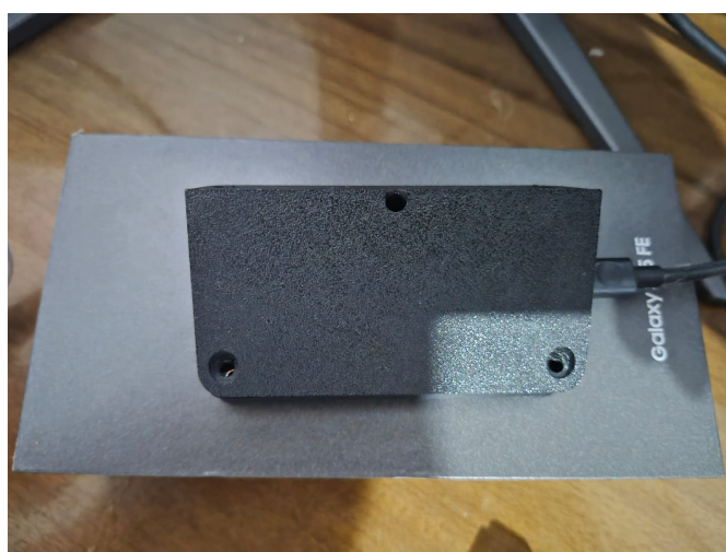
Figura 6 – Invólucro fechado sobre o dispositivo, representando o estado LACRADO utilizado na aquisição das leituras.
