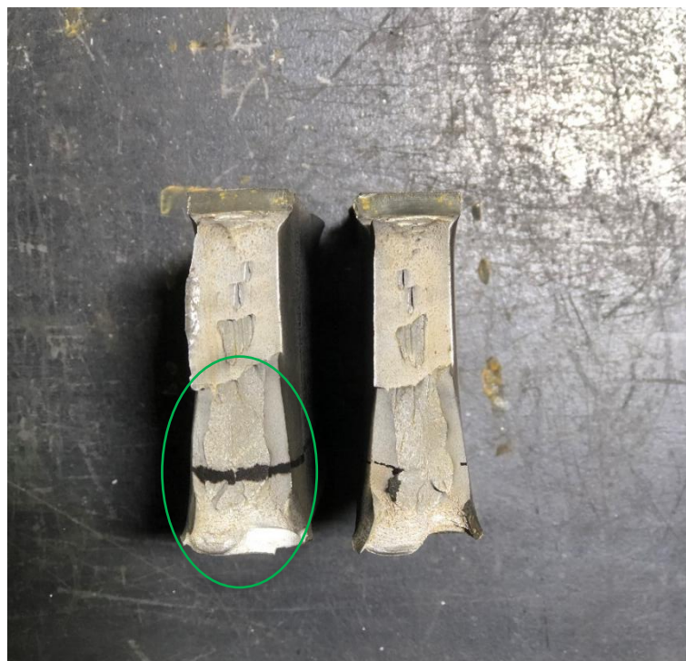
Figura 5.23: Superfície de fratura do corpo de prova DWTT da amostra C2-01(segundo par de amostras), evidenciando região de fratura inversa. (O autor, 2025)
