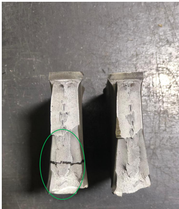
Figura 5.24: Superfície de fratura do corpo de prova DWTT da amostra C2-02, evidenciando região de fratura inversa. (O autor, 2025)
