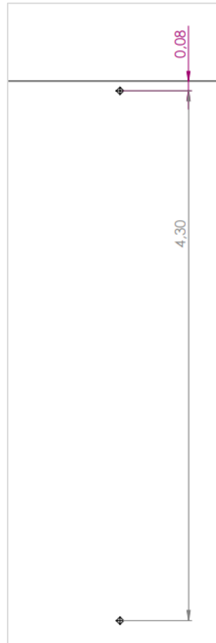
Figura 4.7: Medida entre pontos de medição de microdureza. (O autor,2026)
