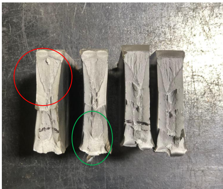
Figura 5.20: Superfície de fratura do corpo de prova DWTT da amostra C1-02, evidenciando região de fratura frágil direta e fração de fratura inversa. (O autor, 2025)
