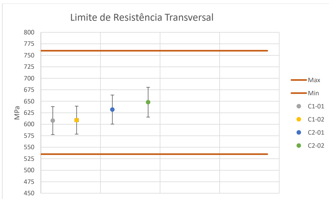
Figura 5.17: Resultados de limite de resistência transversal das amostras avaliadas (O autor, 2026)
