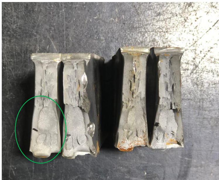
Figura 5.21: Superfície de fratura do corpo de prova DWTT da amostra C1-01, evidenciando região de fratura inversa. (O autor, 2025)
