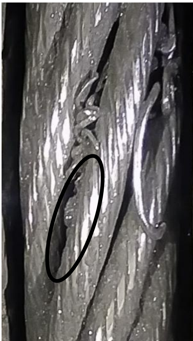
Figura 11: Aumento localizado do diâmetro do cabo de aço. Fonte: Pesquisa Direta (2026)
