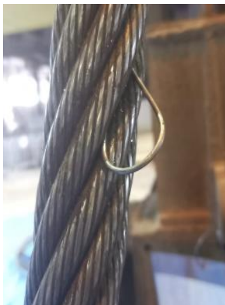
Figura 9: Arame rompido identificado durante inspeção do cabo de aço. Fonte: Pesquisa Direta (2026)
