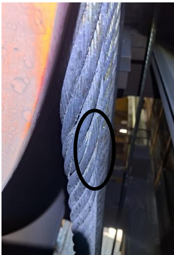
Figura 10: Ocorrência de alma saltada identificada no cabo de aço. Fonte: Pesquisa Direta (2026)
