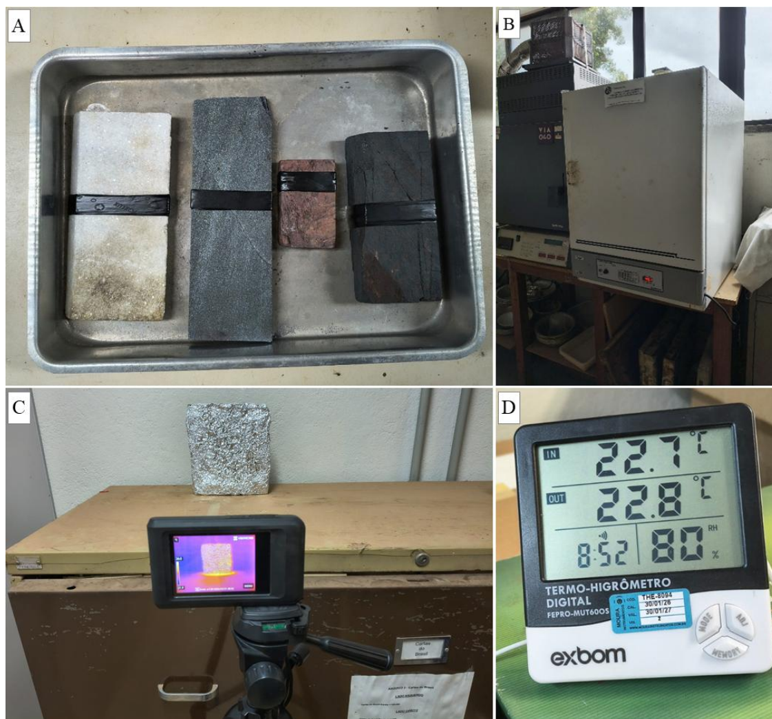
Figura 17: Etapas da abordagem metodológica realizada para determinar a emissividade dos litotipos. Aplicação da fita isolante na superfície da rocha (A); Aquecimento em estufa por 24 horas (B); Aquisição da temperatura aparente (C) e termohigrômetro (D).
