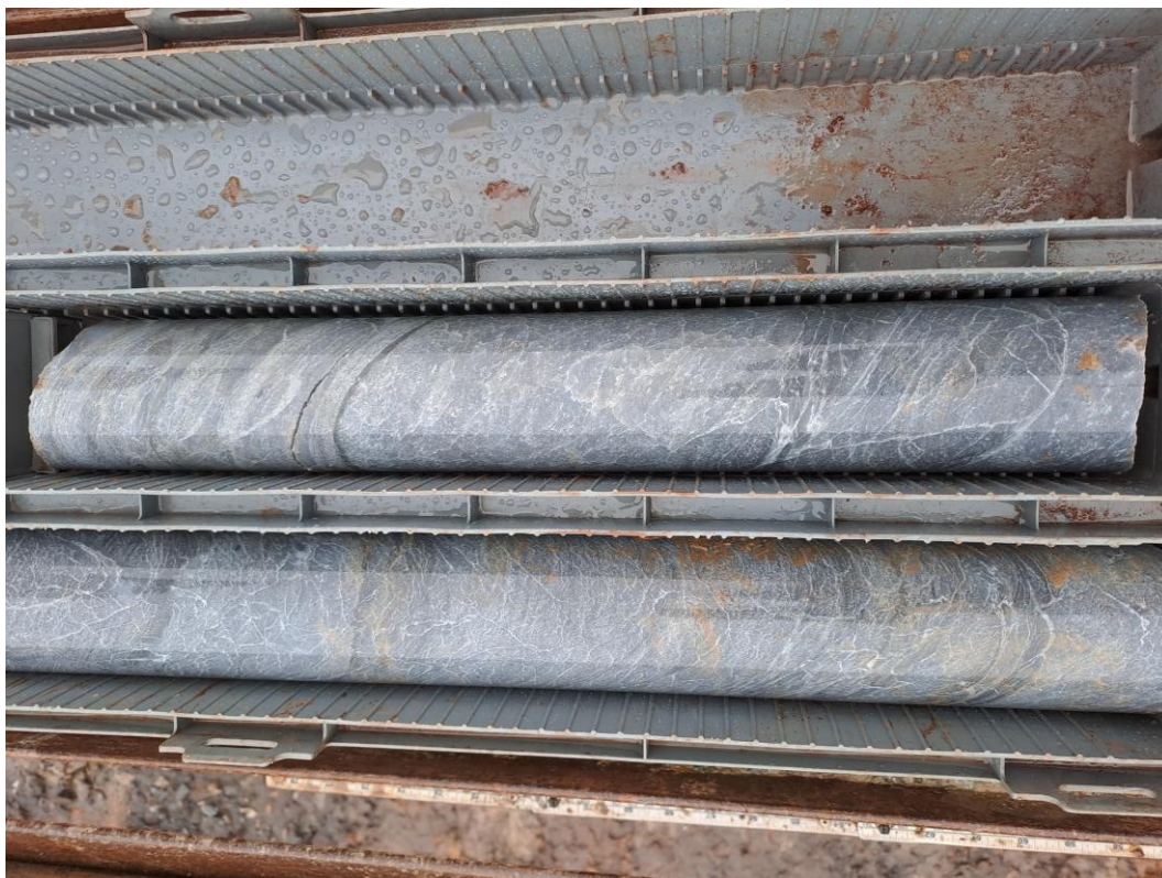
Figura 11: Caixa de testemunho de sondagem constituída por itabirito friável.
