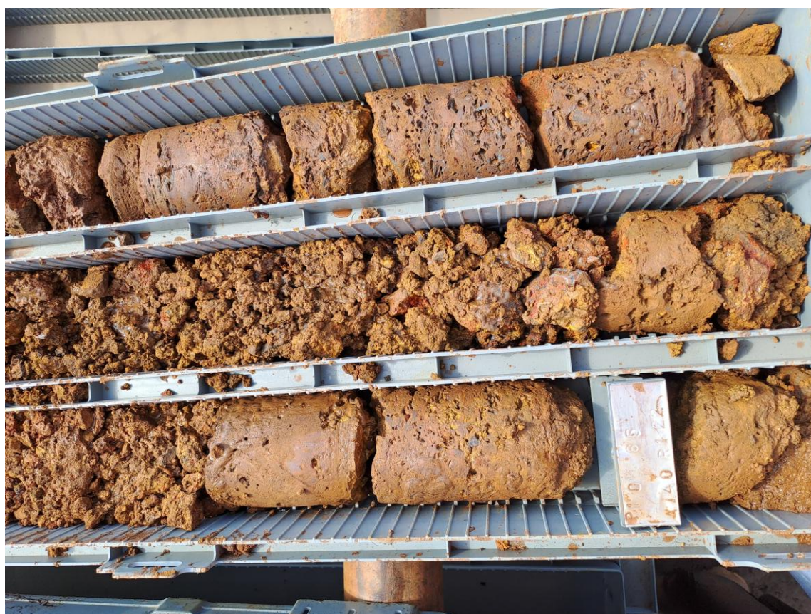
Figura 12: Caixa de testemunho com canga detrítica.
