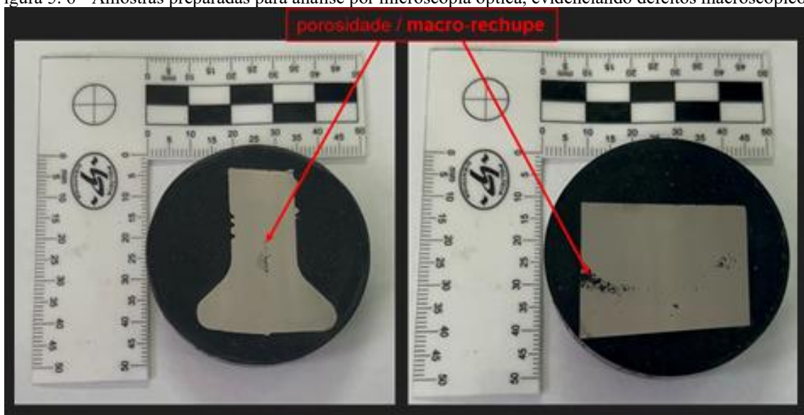
Figura 5. 6 - Amostras preparadas para análise por microscopia óptica, evidenciando defeitos macroscópicos.
