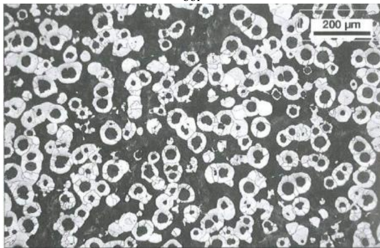
Figura 3. 1 - Imagem por microscopia óptica de ferro fundido nodular. Microestrutura conhecida como “olho de boi”
