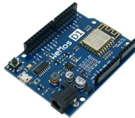
Figura 2 – Placa WeMos D1 R1 WiFi ESP8266
