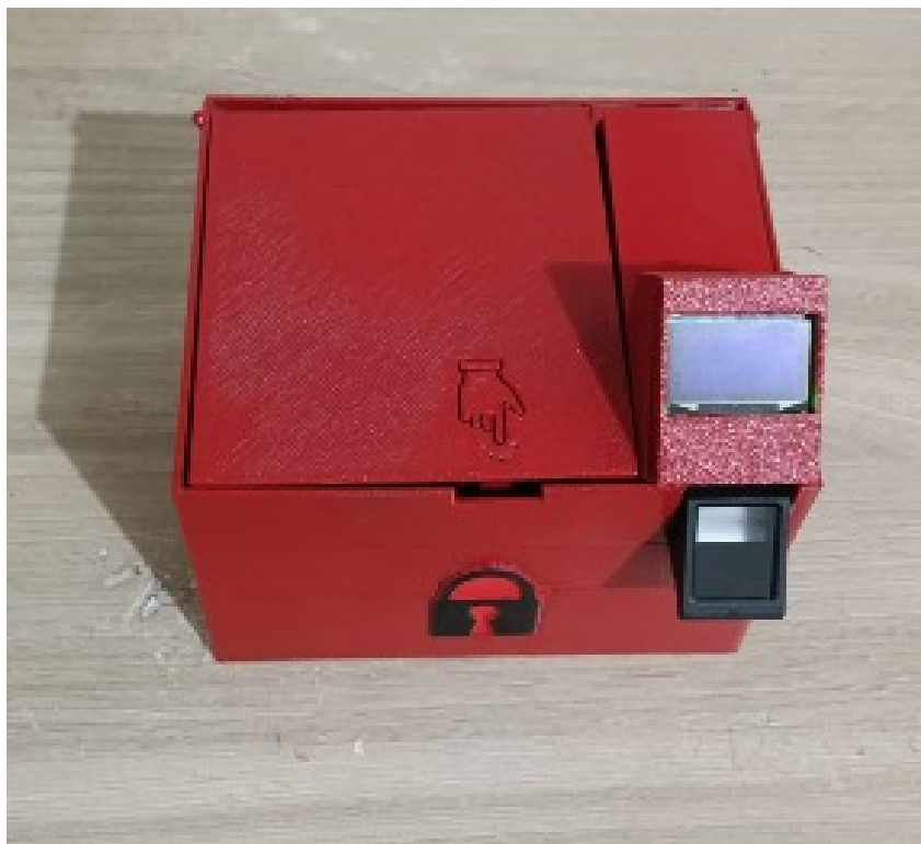
Figura 21 – Caixa de bloqueio biométrica finalizada
