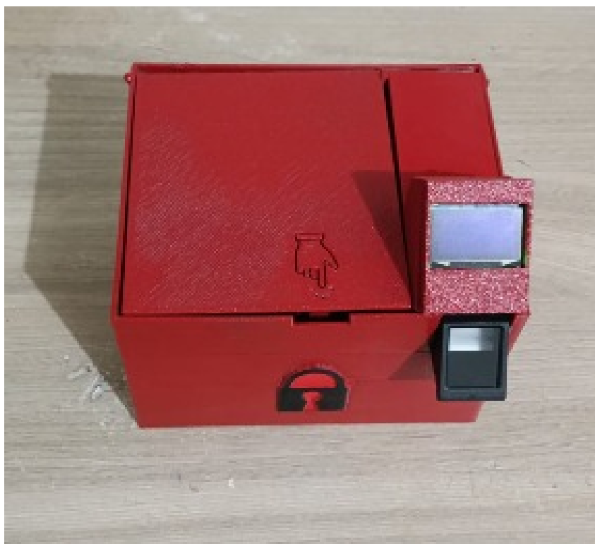
Figura 35 – Visão frontal da versão final da Caixa de Bloqueio Biométrica.
