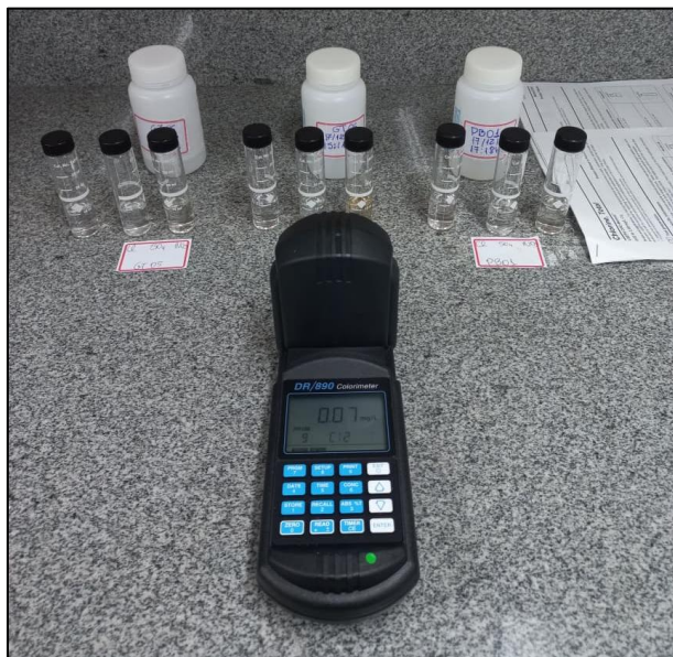
Figura 11: DR 890 Colorimeter utilizado na análise de ânions maiores
