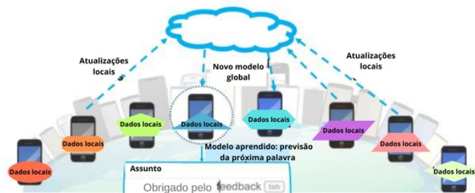
Figura 2.6 – Esquema de uma rede federada (adaptado de (YANG et al., 2019)
