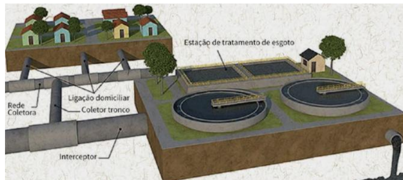
Figura 8 - Sistema de esgotamento sanitário
