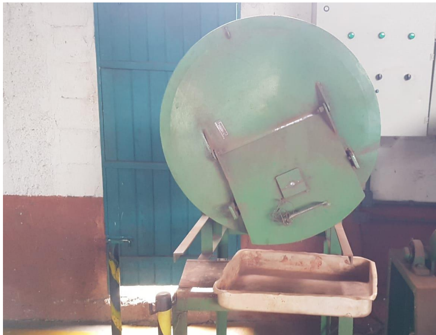
Figura 4.4. Tambor padronizado para o ensaio de tamboramento.
