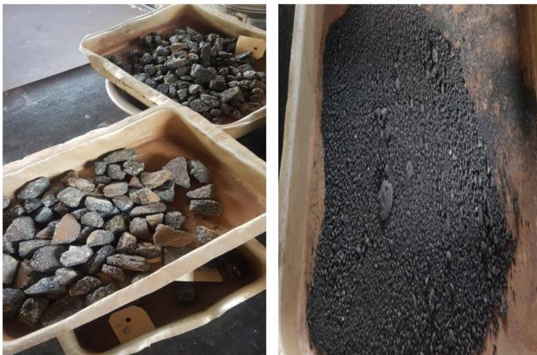
Figura 5.2. Minérios Granulados A e B. À direita, imagem da amostra após o ensaio de RDI.
