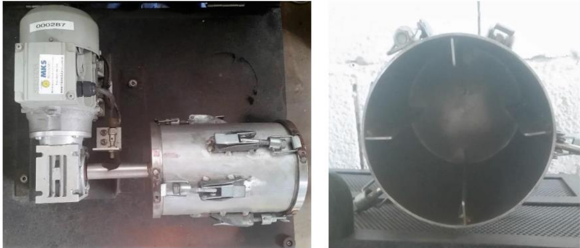
Figura 4.3. Tambor padronizado para tamboramento após ensaio RDI. À direita, detalhe do seu interior (FIGUEIREDO, 2018).
