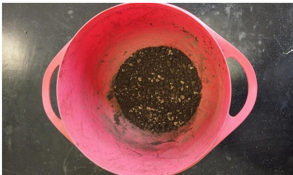
Figura 11: Homogeneização dos finos de manganês e aglomerantes antes do processo de compactação.
