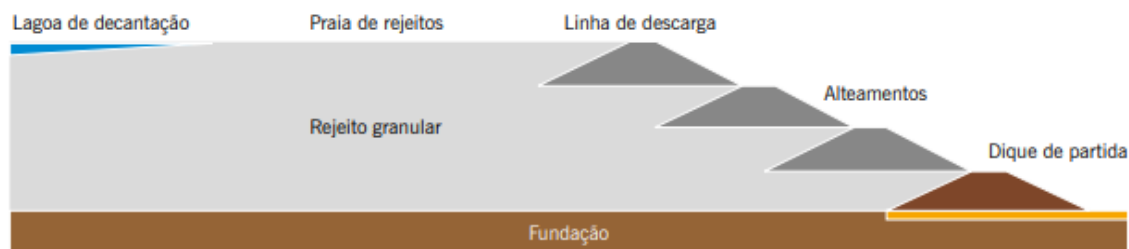
Figura 1 – Método de alteamento a montante. (Acervo IBRAM).
