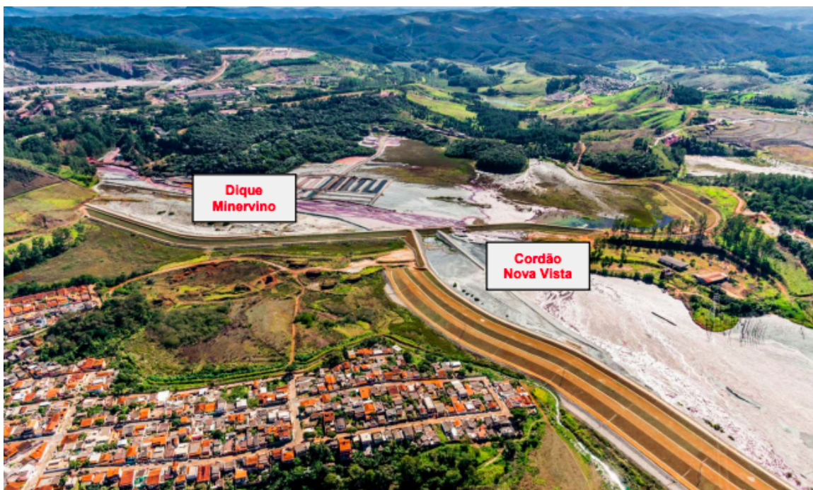
Figura 10 – Foto do avanço do processo de descaracterização do dique Minervino e Cordão Nova Vista. (Vale,2025).
