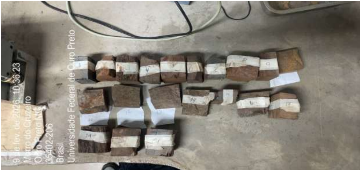
Figura 9 - Corpos de prova rochosos preparados e identificados para a realização do ensaio de carga pontual (PLT).
