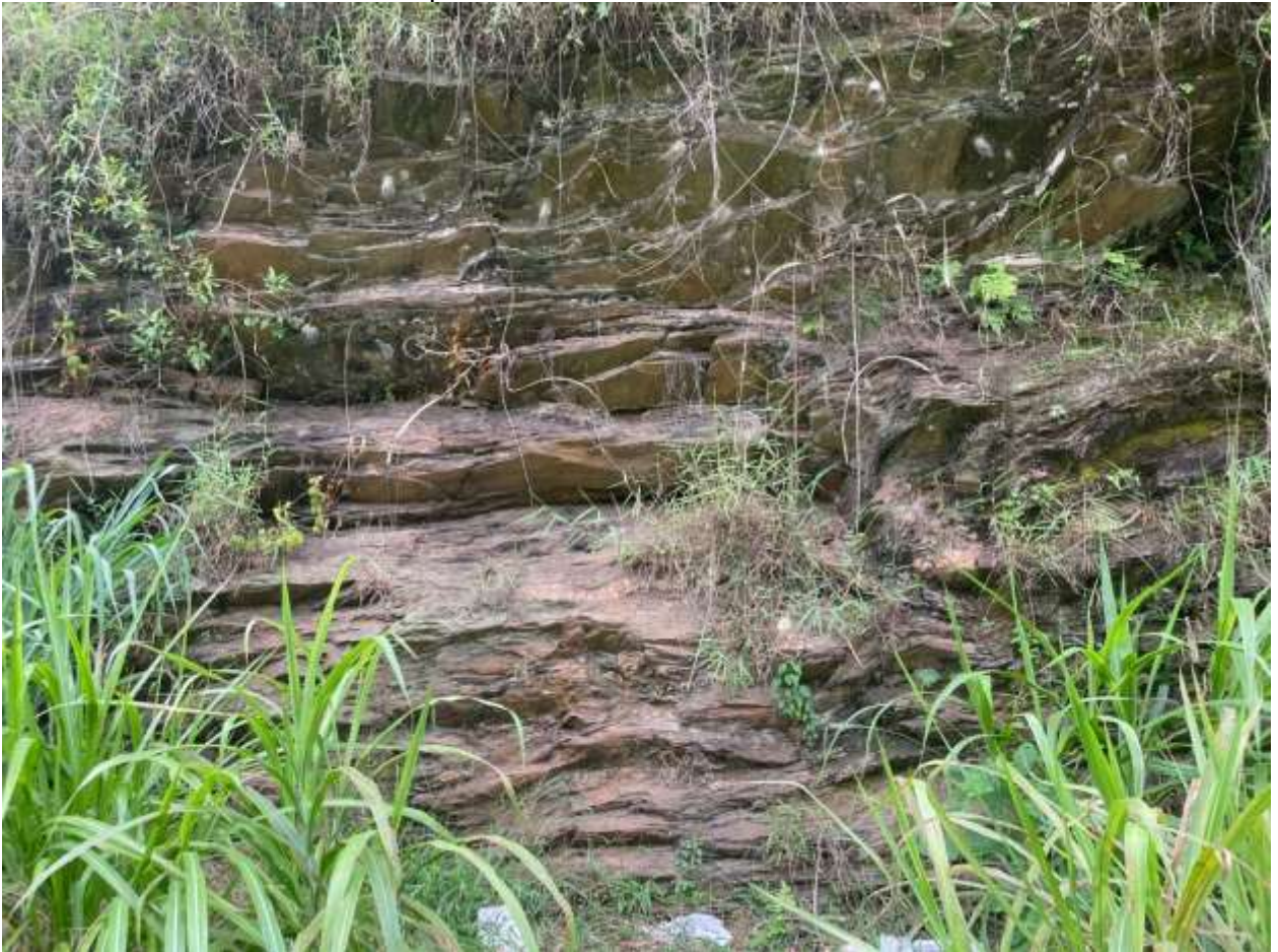
Figura 13 - Vista do maciço rochoso no Ponto 03, evidenciando a foliação e o estado superficial das discontinuidades.
