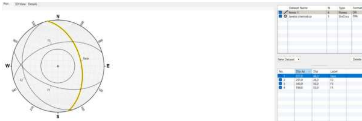
Figura 19 -Rede estereográfica do Ponto 03 com a face do talude e as famílias de descontinuidades.
