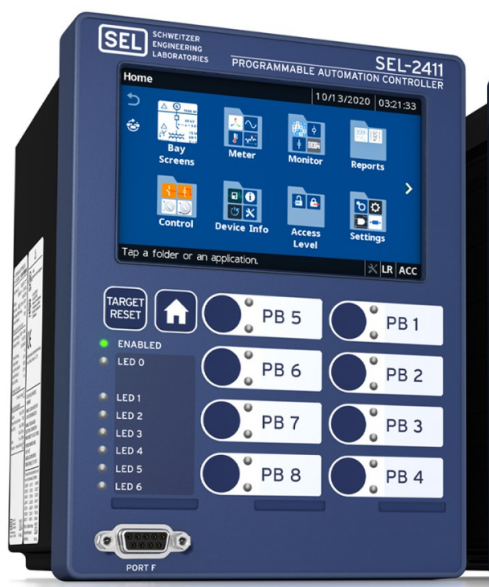
Figura 15 – Controlador de automação em tempo real (RTAC). Fonte: Schweitzer Engineering Laboratories (2025)
