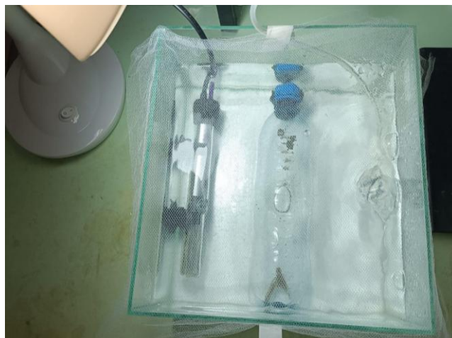
Figura 2 – Sistema experimental para eclosão dos cistos em aquário sob iluminação artificial
