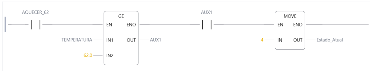
Figura 6 – Transição condicionada ao atingimento de 62°C.
