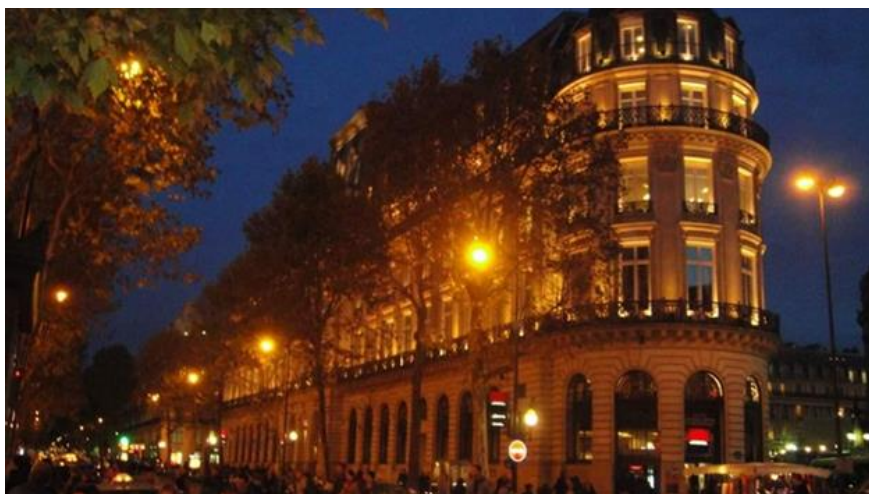
Figura 14 - Rua iluminada com lâmpada de vapor de sódio, tendo ao fundo um edifício iluminado também com temperatura de cor quente
