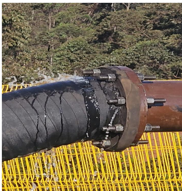
Figura 27 - Ruptura em mangotes Fonte: Pesquisa direta (2025)
