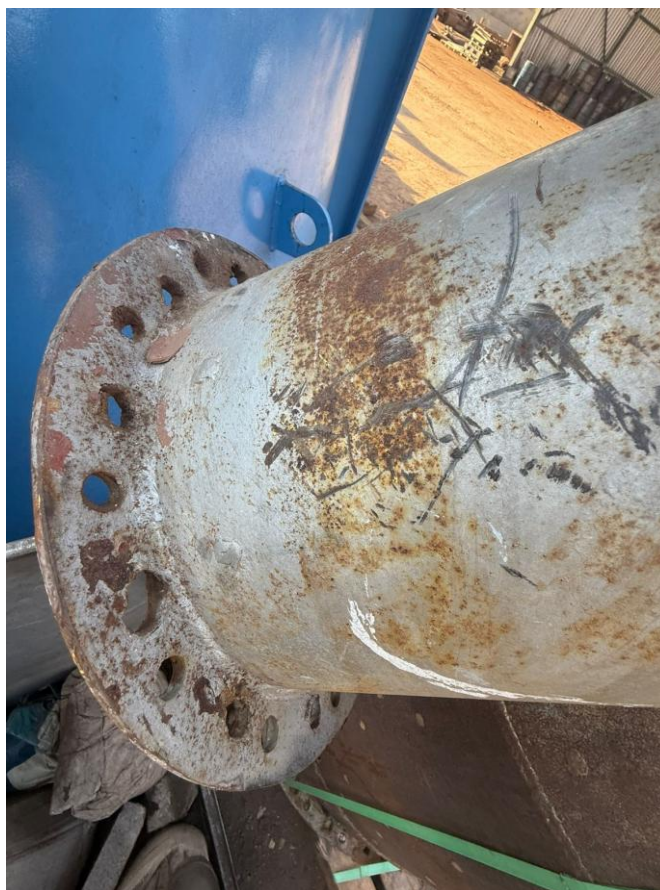
Figura 23 - Falha de flanges Fonte: Pesquisa direta (2025)
