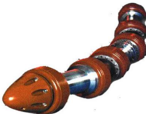
Figura 7 - PIG Ultra Sônico Fonte: SOUZA (2003).
