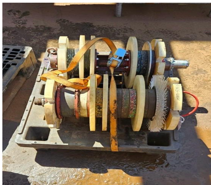
Figura 9 - Pig de limpeza com placa calibradora Fonte: Pesquisa direta (2025).
