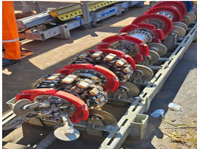
Figura 8 - Caliper PIG Fonte: Pesquisa direta (2025).
