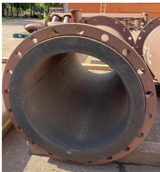
Figura 16 - Tubo de aço revestido de Borracha Fonte: Pesquisa direta (2025).
