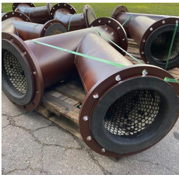
Figura 17 - Tubo revestido de borracha com cerâmica Fonte: Pesquisa direta (2025).
