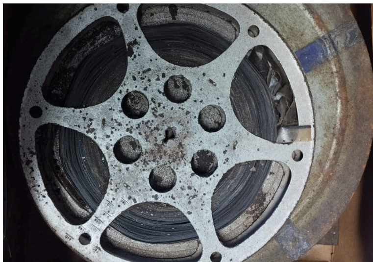
Figura 79- Película de acetato em carretel de metal oxidado, com presença de microrganismos, abaulamento, ressecamento, sujidades e síndrome do vinagre.
