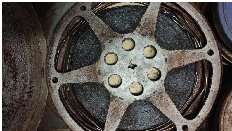
Figura 77- Película de acetato em carretel de metal oxidado, com presença de microrganismos, abaulamento, ressecamento, sujidades e síndrome do vinagre.
