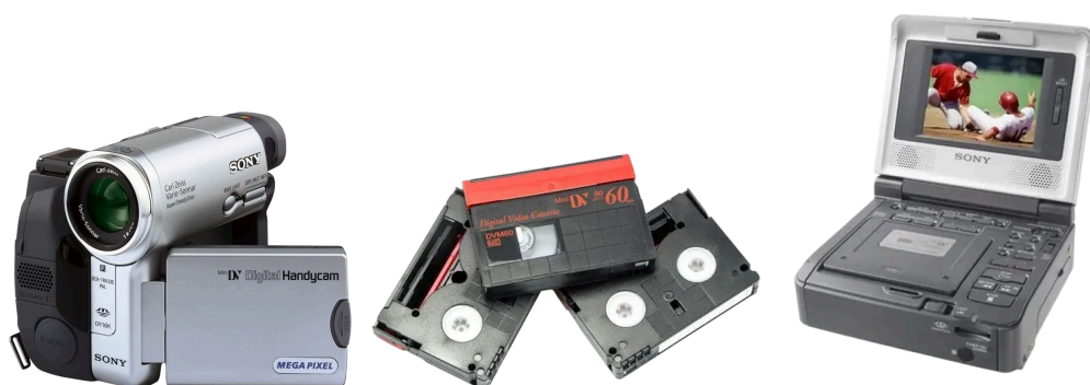
Figura 12, 13 e 14- Câmera utilizada para gravação da fita Mini DV, Fitas miniDV e Unidade de Reprodução e edição.
