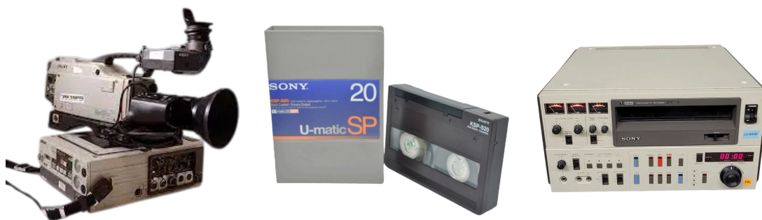
Figura 06, 07 e 08- Câmera para gravação na fita, Fita U-Matic (SP) e Unidade de reprodução.
