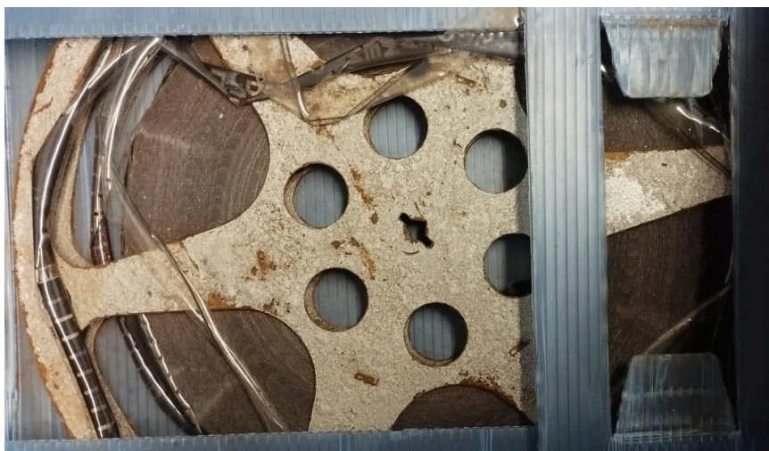
Figura 82- Película de acetato em carretel de metal oxidado, com presença de microrganismos, abaulamento, ressecamento, sujidades e síndrome do vinagre.
