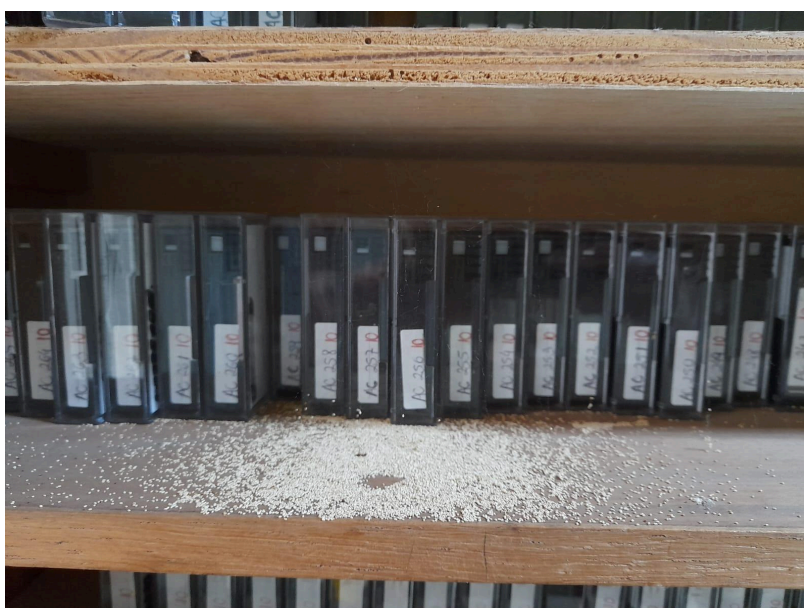
Figura 40- Excrementos de cupim identificados no mobiliário junto às fitas MiniDV.
