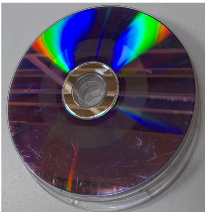
Figura 45- Ranhuras na parte reflexiva do CD, comprometendo a leitura de seu conteúdo.
