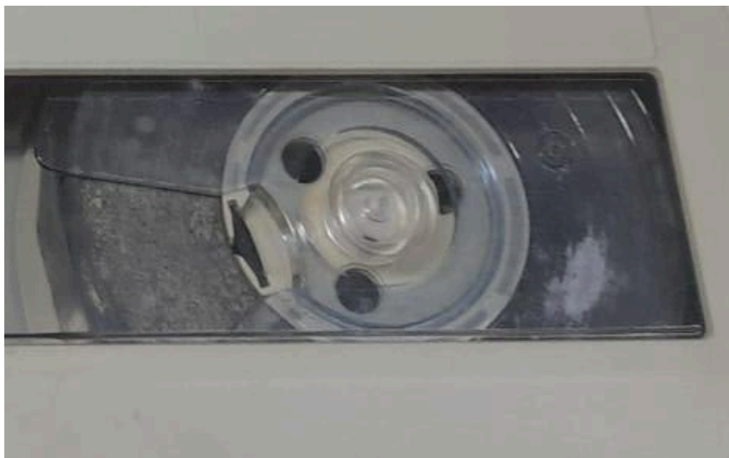
Figura 65- Fita U-matic com a presença de microrganismos-mofo.
