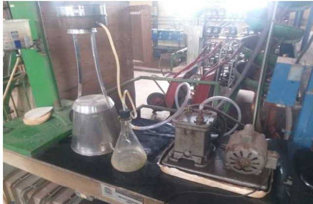
Figura 13: Sistema de Kitasato e bomba acoplado a montagem da peneira e fundo. Fonte: Elaborado pelo autor (2022).
