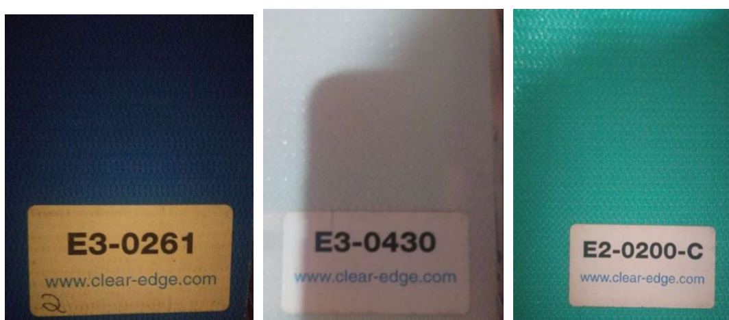
Figura 5: Meios filtrantes utilizados nos testes: E3-0261 (azul), E3-0430 (branco) e E2-2000-C (verde).
