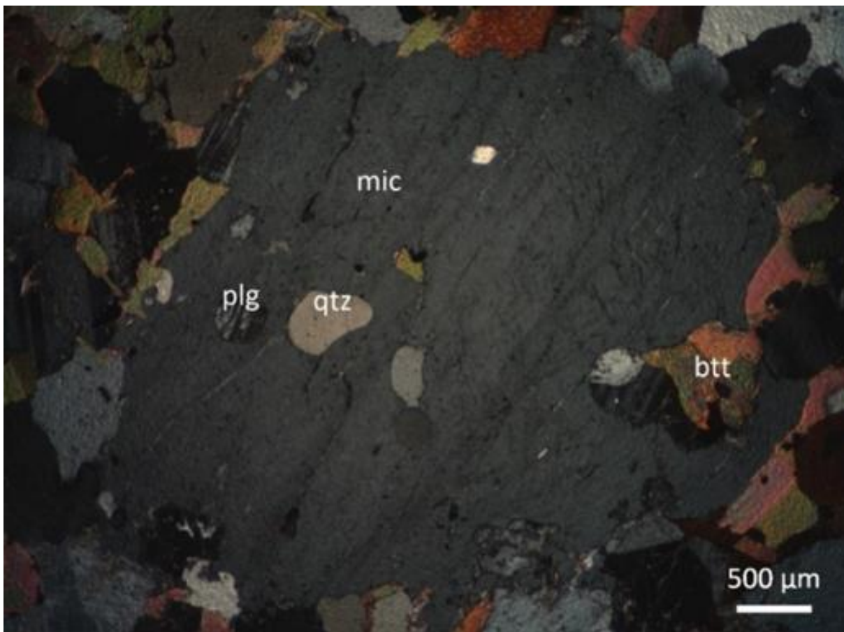
Figura 3.23: Grão de microclínio médio poiquilítico com inclusões de quartzo, plagioclásio e biotita de granulação fina (LG29).
