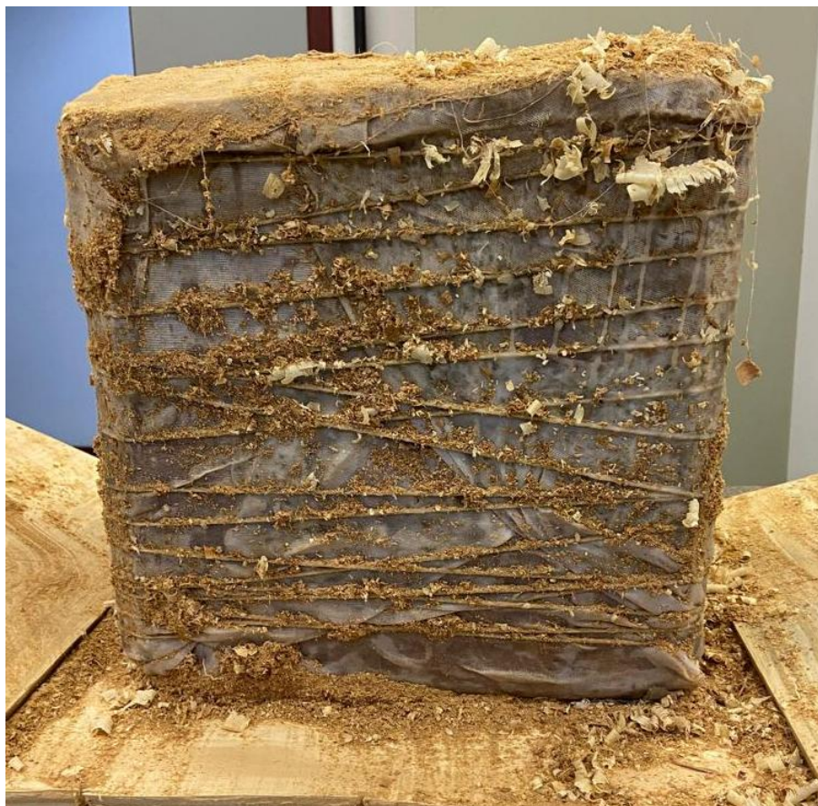
Figura 11: Amostra indeformada coletada por empresa terceirizada especializada.
