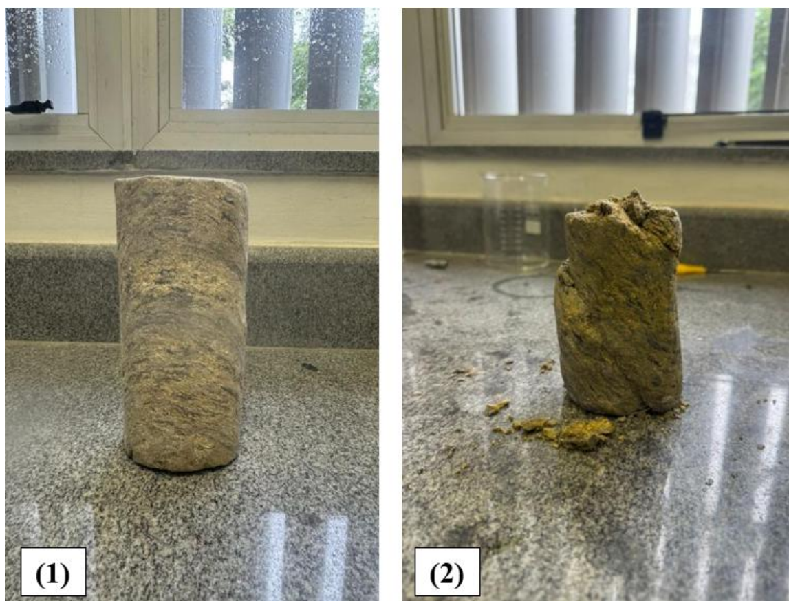
Figura 21: Corpos de prova de solo coletado no talude B antes (1) e após (2) a realização do ensaio.
