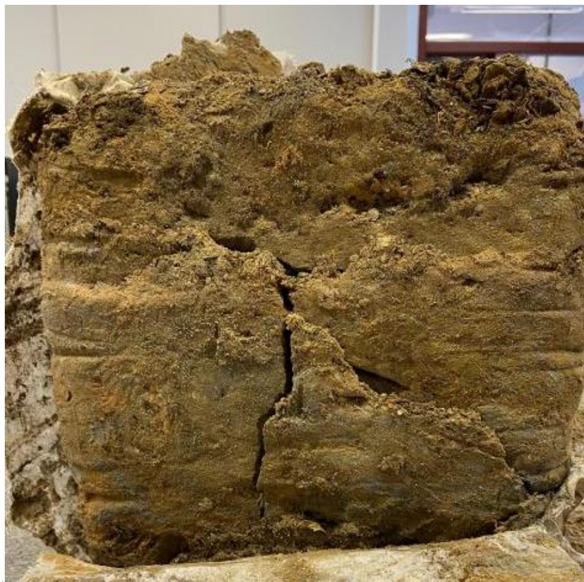
Figura 26 Amostra indeformada do talude C.
