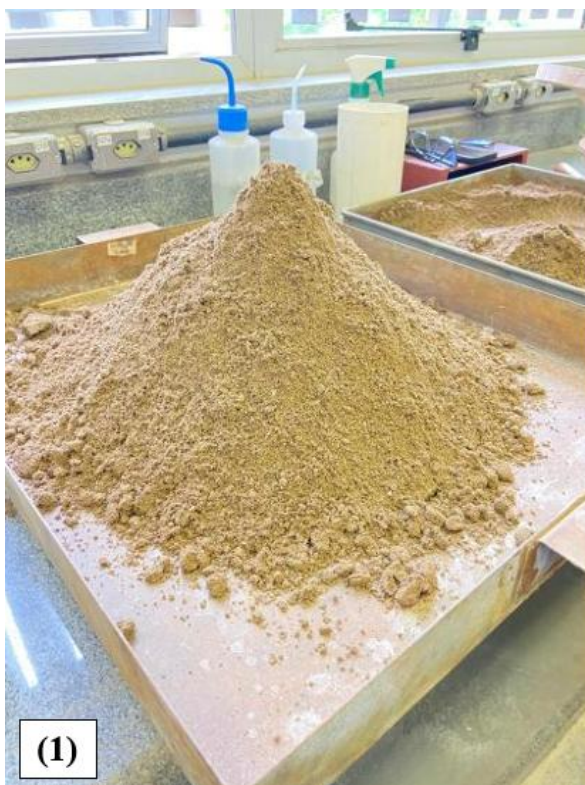
Figura 27: Preparação de corpos de prova via amostra deformada. (1) homogeneização e (2) compactação.
