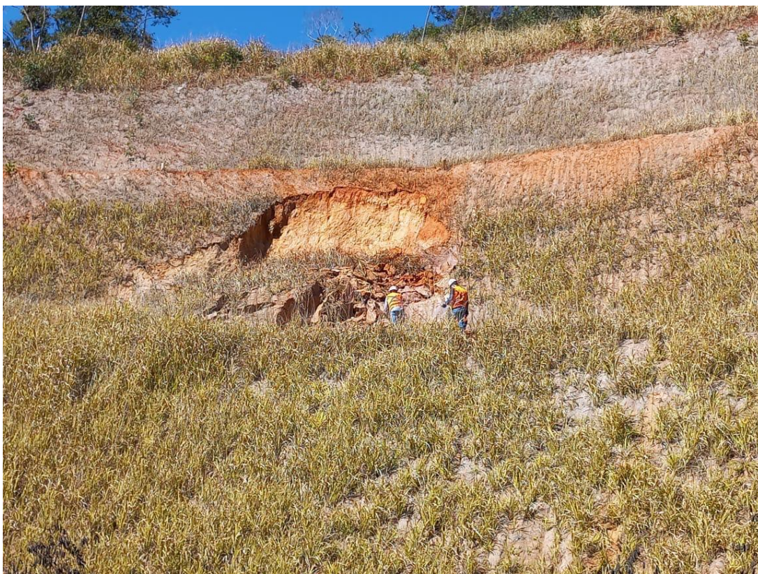
Figura 10: Coleta de amostra deformada.
