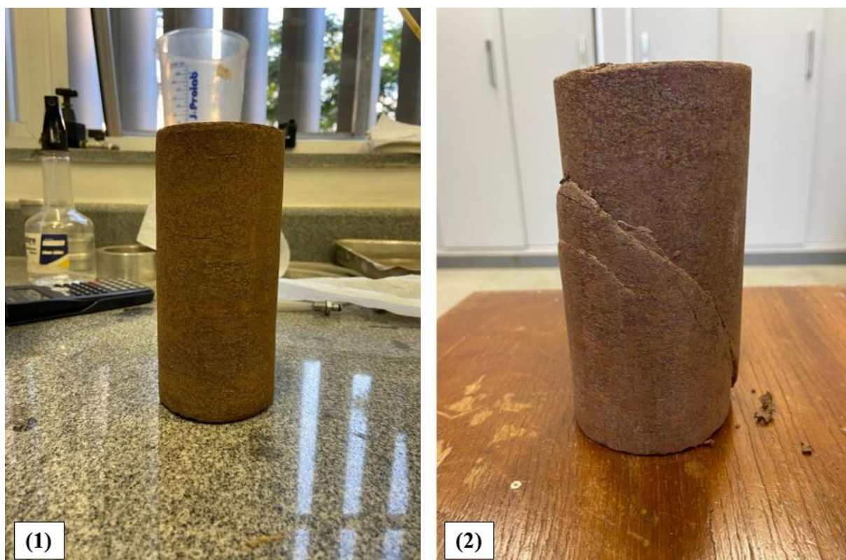
Figura 16: Corpo de prova de solo do talude A antes (1) e após (2) a realização do ensaio.
