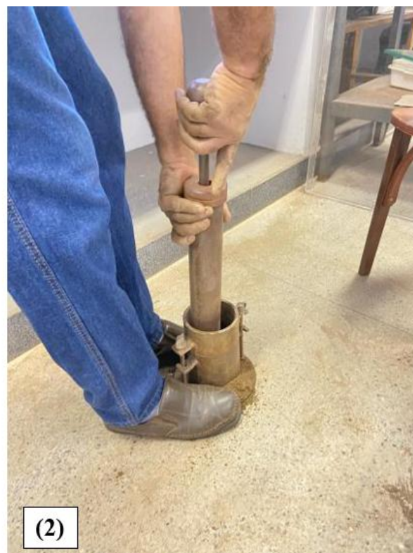
Figura 27: Preparação de corpos de prova via amostra deformada. (1) homogeneização e (2) compactação.
