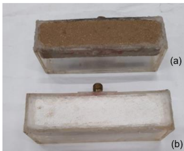
Figura 4.3 - Vista superior do sistema com caixa acrílica para aquisição de imagens das bolhas formadas pela injeção de gás no refratário.
