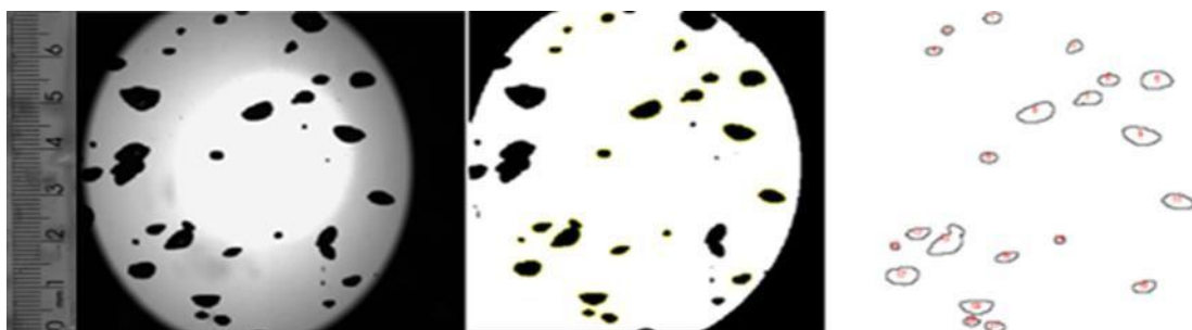
Figura 5.3 – Medição das bolhas ImageJ ® vazão 1 L/min
