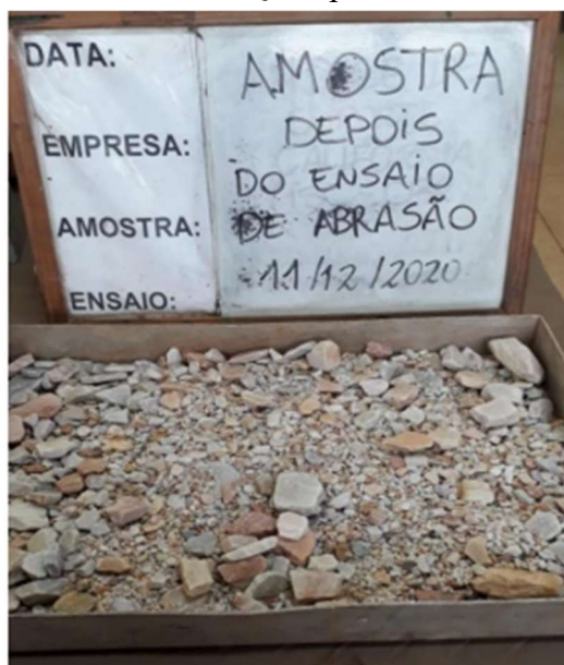
Figura 16 - Amostra do RQF depois do ensaio de abrasão.
