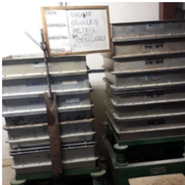
Figura 14 - Análise granulométrica do RQF.
