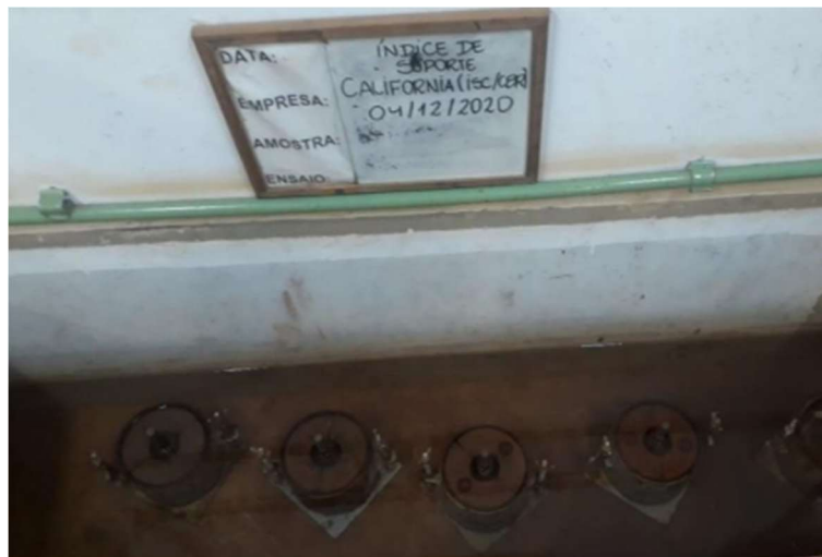
Figura 11 - Índice de Suporte Califórnia (Imersão).
