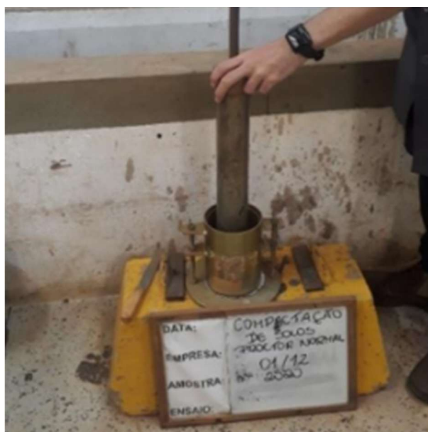
Figura 10 - Compactação do RMF - Proctor normal.
