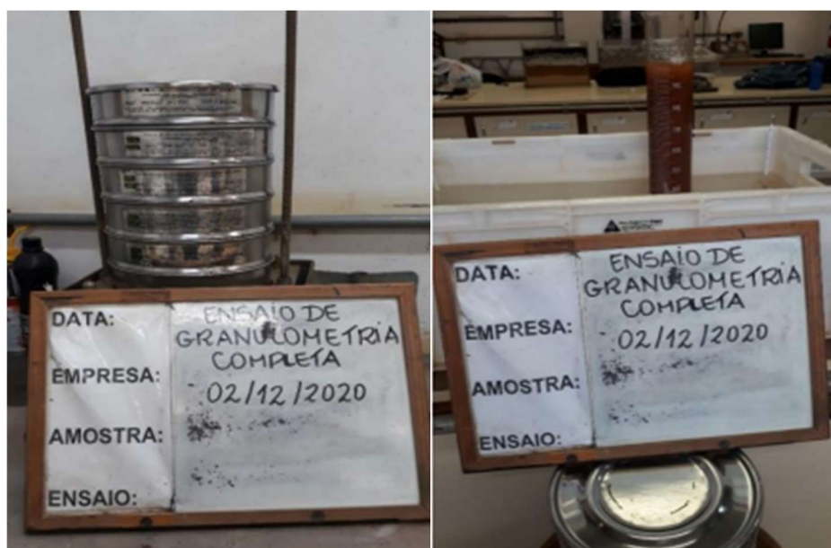
Figura 9 - Ensaio de granulometria completa: peneiramento e sedimentação
