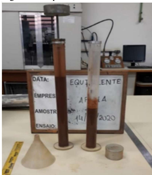
Figura 13 - Equivalente de areia do RMF.
