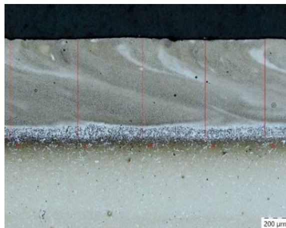
Figura 4.2.3 – Espessura da Camada Aspergida por Calculada por Microscópica Óptica.
