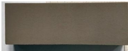
Figura 4.1.1 – Amostra Revestida por Meio da Técnica HVOF.
