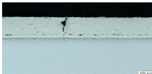
Figura 5.1.4 – Revestimento HVOF sobre aço ferramenta H13 do fornecedor 2 com trinca.
