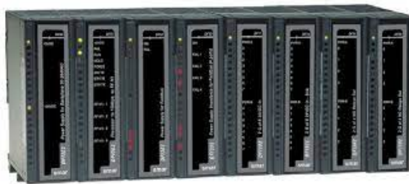
Figura 6 – Plataforma de controle e automação de processos DFI302.
