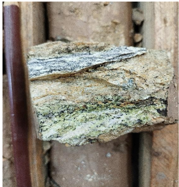
Figura 4.11 - Amostra de mão de rocha calco-silicática, com presença de possível lizardita. Diâmetro Hq (6,35cm).
