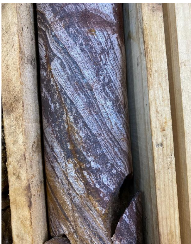
Figura 4.4 - Amostra de mão de itabirito quartzoso compacto. Bandas de quartzo e óxido de ferro bem delimitadas. Diâmetro Hq (6,35 cm).
