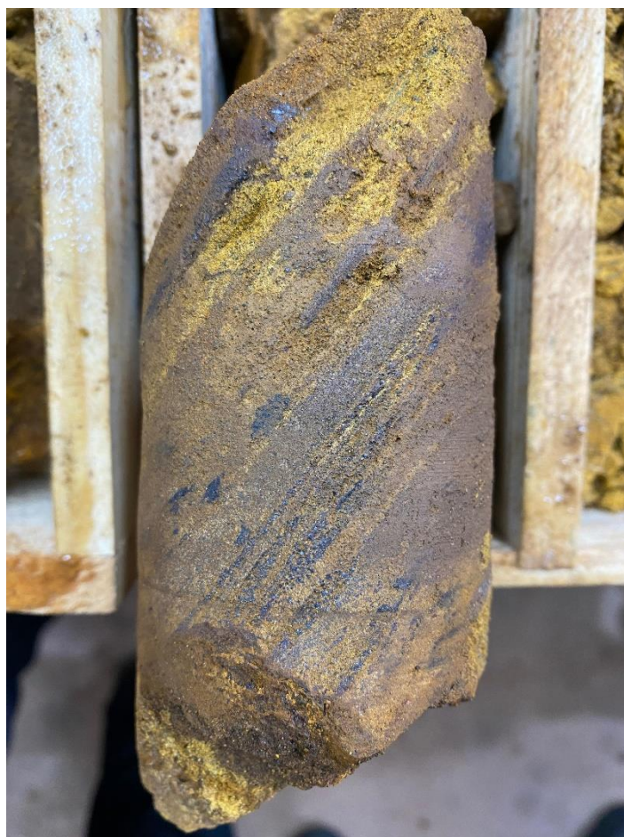
Figura 4.3 — Testemunho de sondagem de itabirito goethítico compacto. Bandas de quartzo e óxido e hidróxidos de ferro bem delimitadas. Diâmetro Hq (6,35 cm).
