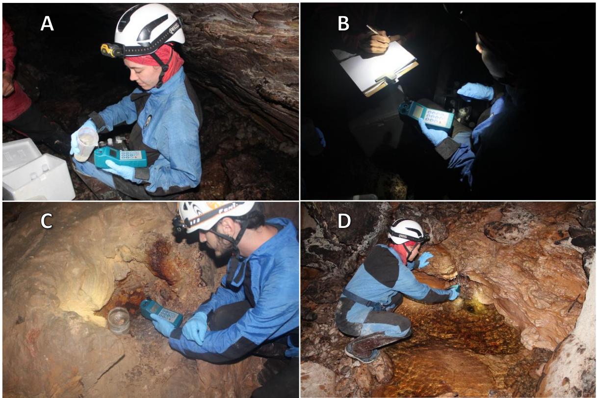
Figura 18: Medição dos parâmetros físico-químicos de água de fluxo e água de gotejamento da Caverna Bento I. A) água de gotejamento em PA1. B) anotação das medidas observadas em PA2. C) água de fluxo em PA4. D) água de gotejamento em PA5.
