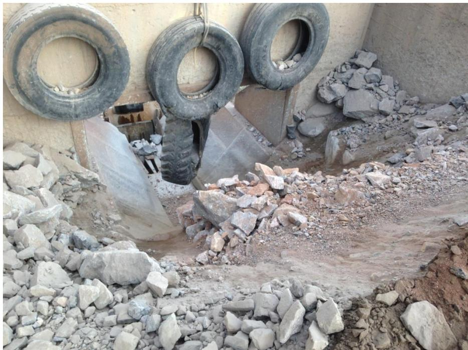
O material britado é conduzido em calha fixa para uma pilha, que em seguida é retomada através de um alimentador vibratório (AV), para um transportador de
