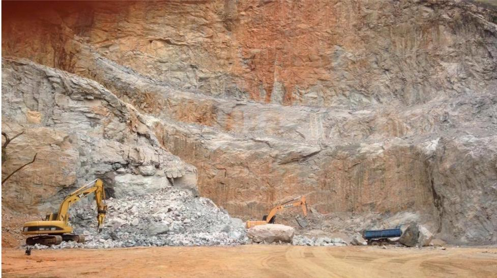
Uma planialtimetria detalhada da área *versus* observação da extensão do afloramento local, permitiu o traçado de uma cava final que guiasse o desenvolvimento da lavra nos anos posteriores.
