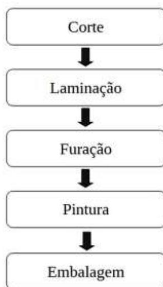
Figura 3 - Fluxograma do processo produtivo de uma indústria moveleira.
