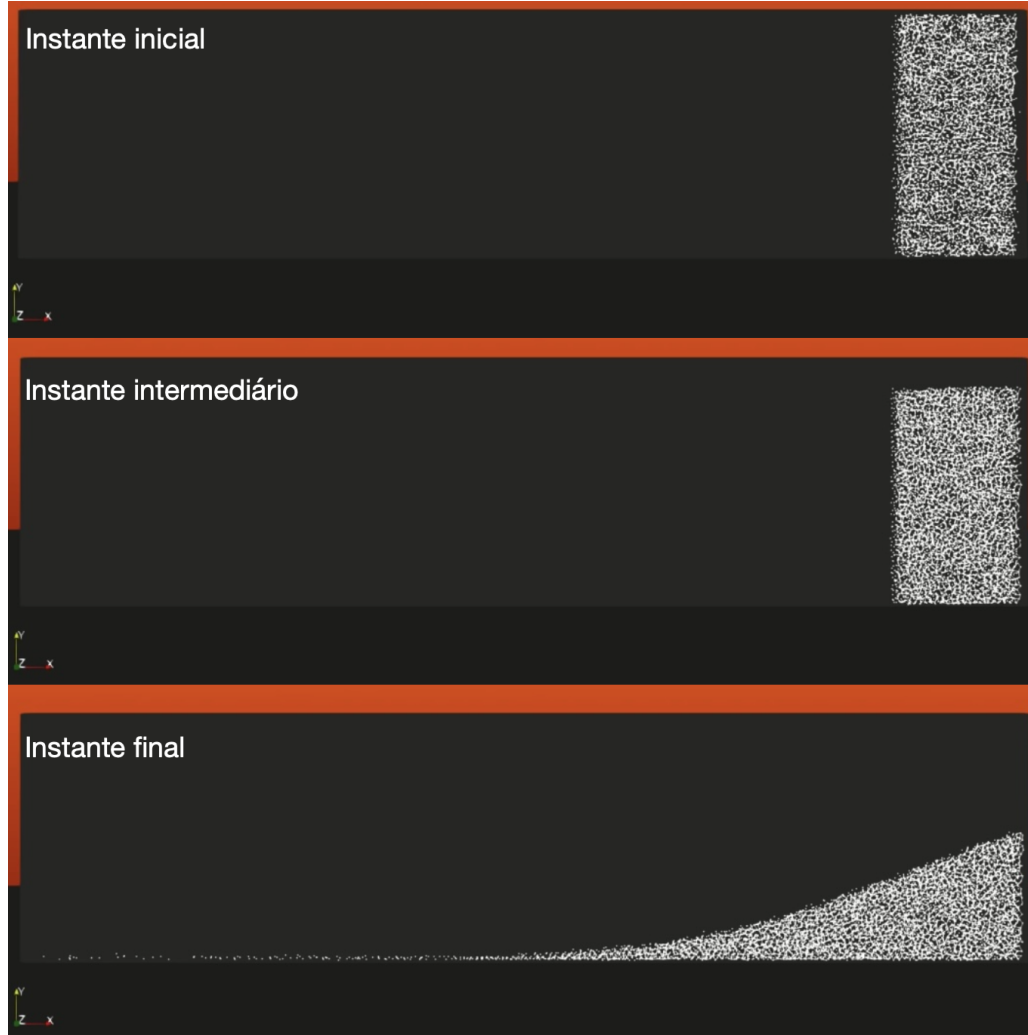
Figura 10 – Extratos de resultados obtidos em simulação de colapso granular de esferas de vidro à seco no YADE
