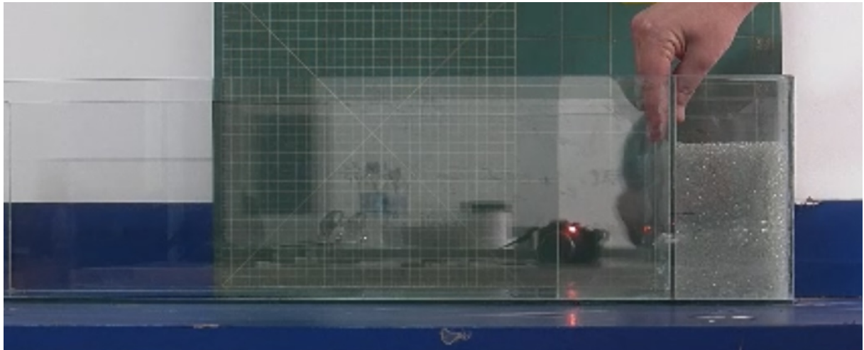
Figura 7 – Aparato experimental do experimento de colapso granular de esferas de vidro secas
