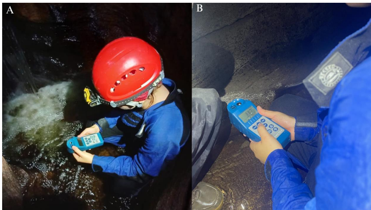
Figura 2.2: Medição dos parâmetros físico-químicos com o uso do multiparâmetro portátil
