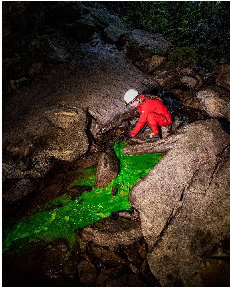
Figura 2.4: Injeção da Fluoresceína Sódica na Gruta dos Coelhos.
