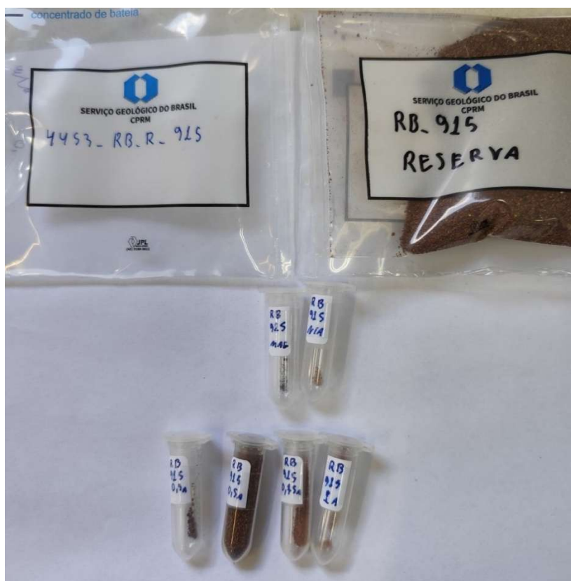
Figura 8 - Relação entre a susceptibilidade magnética por amostras. Destaque para a variação quantitativa de material, visualizada ao longo da variação das amperagens.
