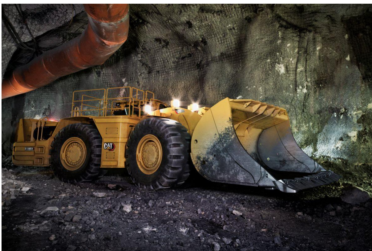
Figura 4 – LHD em Operação Teleoperada no Subsolo
