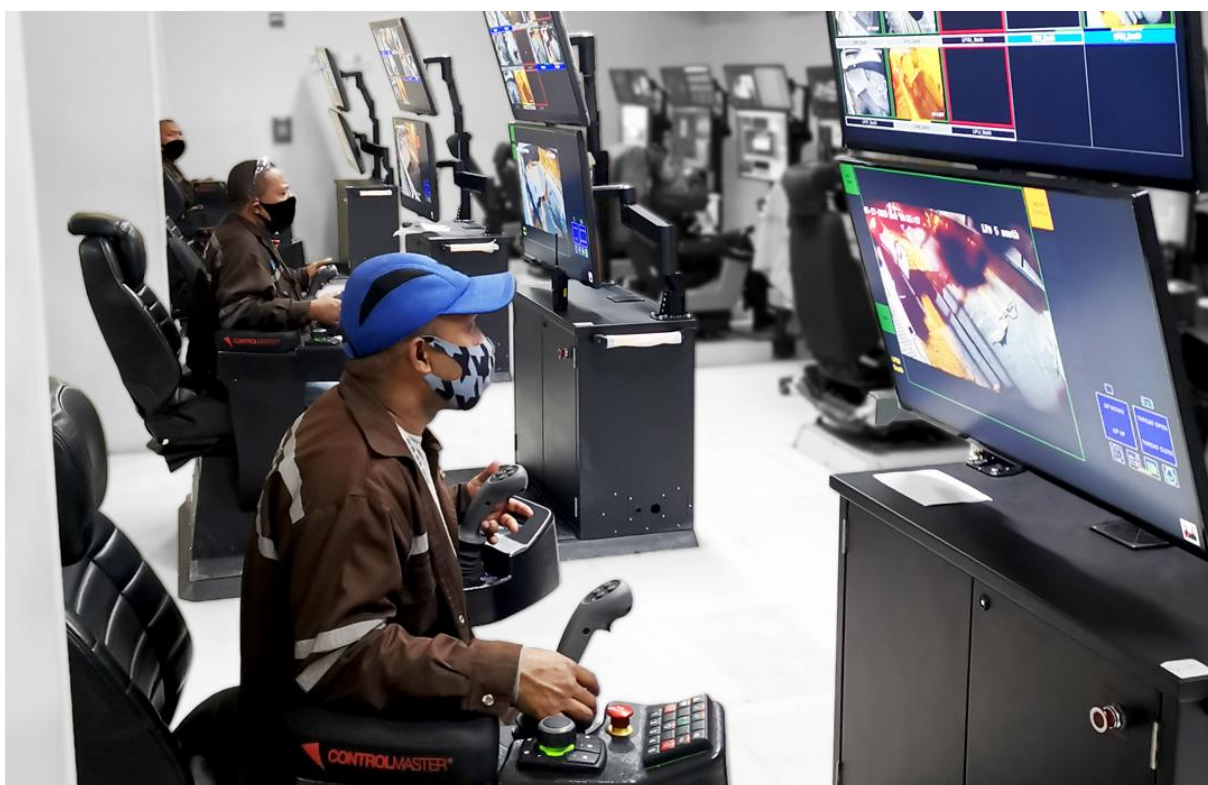
Figura 1 – Exemplo de Estação de Controle Remoto de LHD
