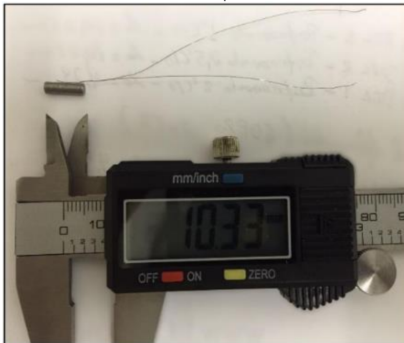
Figura 2.2 – Fotografia de um corpo de prova de dilatometria com um termopar do tipo K soldado à superfície
