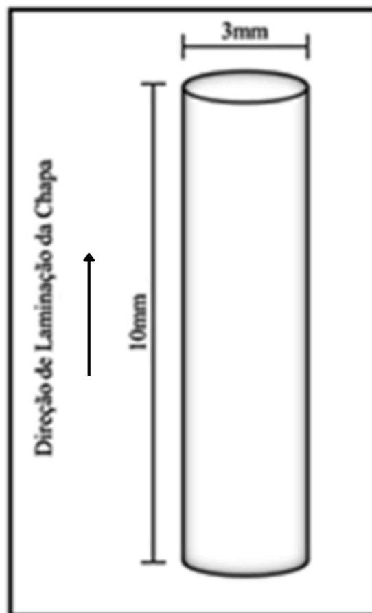
Figura 2.1 - Figura esquemática ilustrando a geometria e as dimensões dos corpos de prova de dilatometria utilizados neste trabalho
