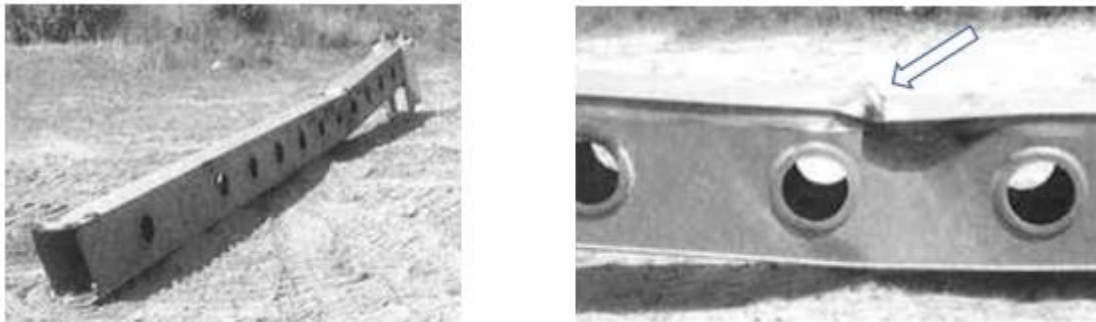
Figura 5 - Flambagem inelástica localizada Fonte: Adaptado de Hibbeler (2010).
