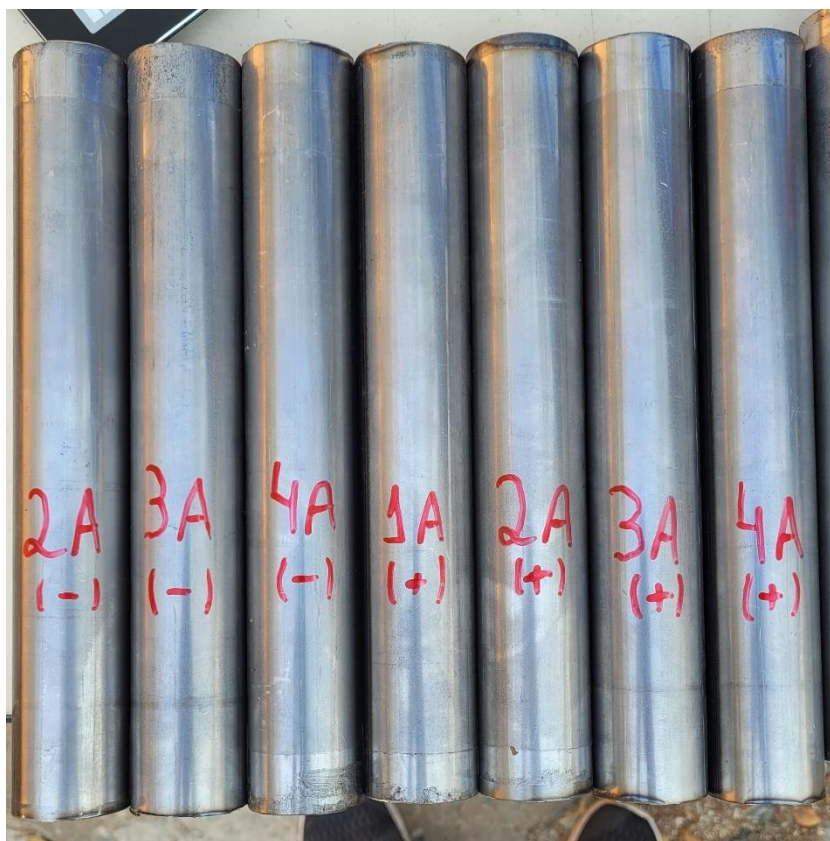
Figura 20 - Corpos de prova de seção transversal circular prontos para os testes de colisão Fonte: Pesquisa direta (2025).
