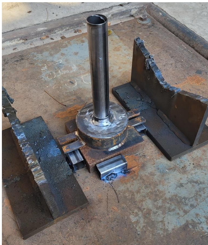
Figura 23 - Corpo de prova redondo fixado na base Fonte: Pesquisa direta (2025).
