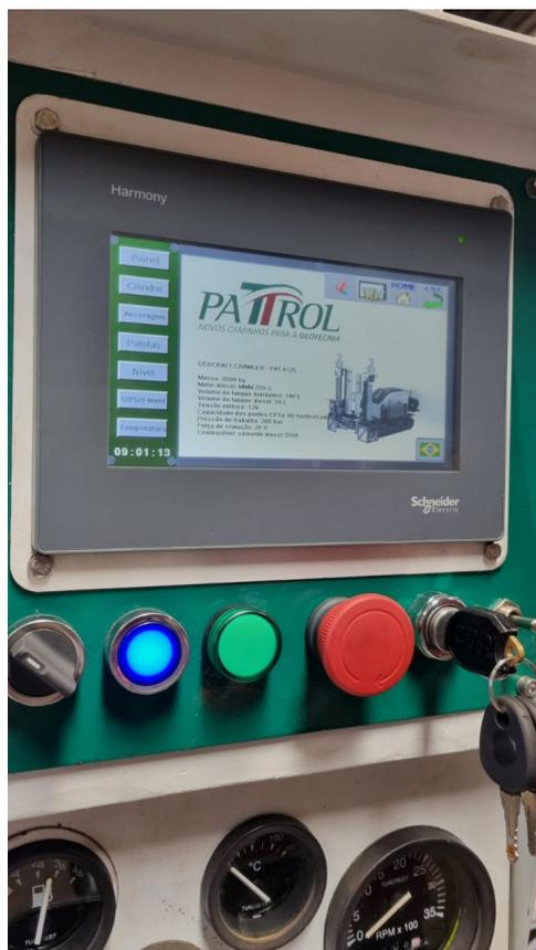
Figura 14 – IHM da Schneider Electric, modelo: Harmony-ST6HMIST6400. Fonte: [Pattrol \(2024\)](#).
