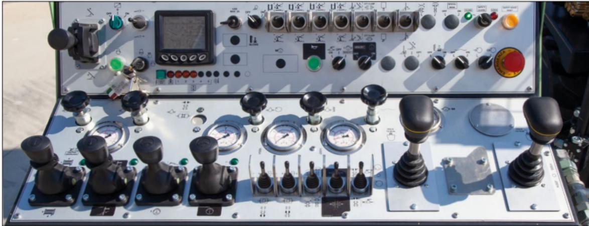
Figura 4 – Painel de controle da Multidrill ML. Fonte: [Fraste \(2025\)](#).
