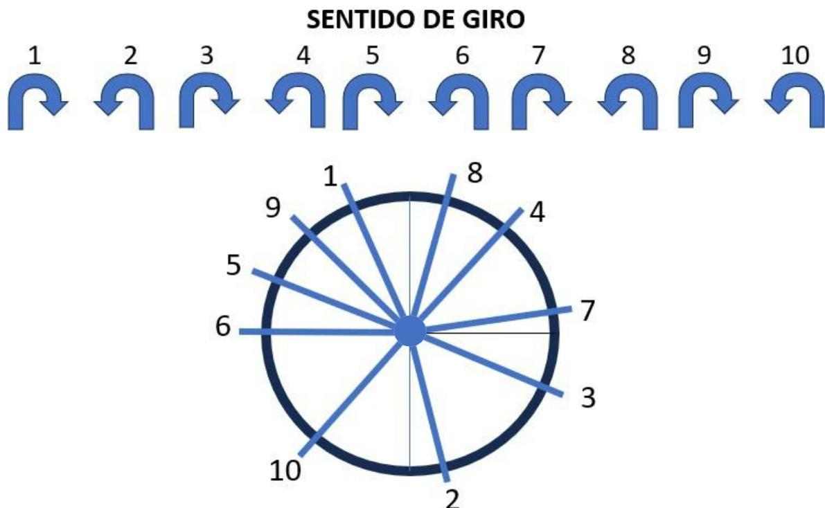
Figura 32: Pontos de parada do chumbo de balanceamento.
