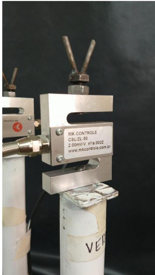
Figura 19: Célula de carga sensor
