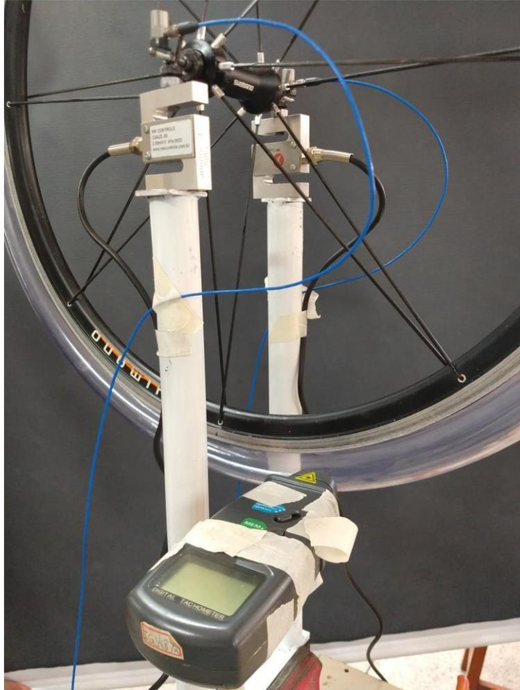
Figura 31: Tacômetro digital para medição através de infravermelho da rotação da roda. Fonte: Pesquisa direta (2024).
