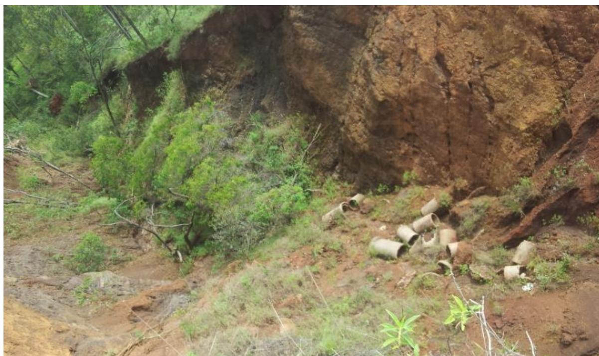
Figura 4: Destroços da tubulação de concreto de condução de água e esgoto que existia onde hoje encontram-se as erosões.
