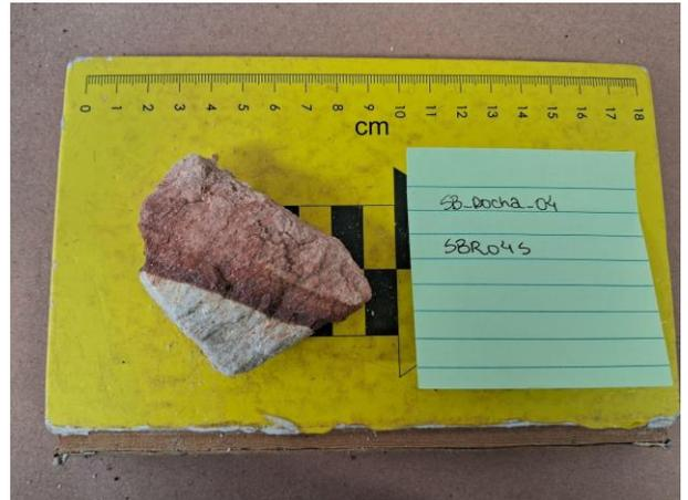
Quartzito da Fm. Moeda com veio e porções ferruginosas. Coordenadas UTM: Zona 23K, X: 656133, Y:7748393, Z: 1424 m.
