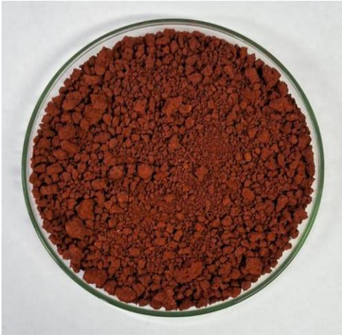
Amostra em Horizonte B latossólico (Bw) de latossolo vermelho pertencente à Fm. Cauê. Coordenadas UTM: Zona 23K, X: 656210, Y: 7747654, Z: 1480 m.
